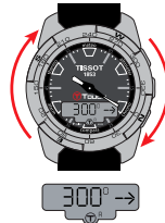
b) Tourner à droite l'axe 6h-12h pour aligner 12h avec la direction azimutale
