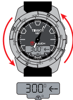
a) Tourner à gauche l'axe 6h-12h pour aligner 12h avec la direction azimutale
