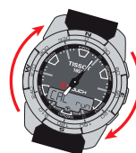
Tourner la montre sur plus qu'un tour complet sur un plan horizontal (p.ex table) dans un endroit sans perturbations magnétiques avec une vitesse de rotation d'environ 30° par seconde. Durée totale: 20 secondes maximum
