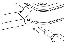
4 本の六角穴付きビス(6 溝／直径 1.3 mm)がブレスレットをケースのアタッチメントに固定しています。このビスは化粧箱の中にある時計に付属の 2 つの専用工具を使用して慎重に取り扱う必要があります。
