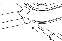
Los 4 tornillos de cabeza hueca (hendidura hexagonal/1,3 mm de diámetro) sirven para fijar la pulsera a las fijaciones de la caja. Estos tornillos deben manipularse con precaución utilizando las dos herramientas adecuadas incluidas en el estuche del reloj.
