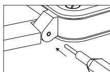
Les 4 vis à tête creuse (creux à 6 pans / 1,3 mm de diamètre) permettent de fixer le bracelet sur les attaches du boîtier. Ces vis doivent être manipulées avec précaution en utilisant les 2 outils adéquats livrés avec la montre dans son écrin.
