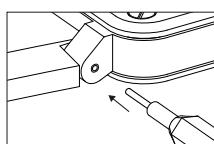
Os 4 parafusos de cabeça oca (cabeça oca hexagonal/1,3 mm de diâmetro) servem para fixar o bracelete nas asas da caixa. Estes parafusos devem ser manuseados com cuidado, utilizando as 2 ferramentas adequadas fornecidas com o relógio, dentro do estojo.
