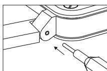
4개의 소켓 헤드 나사(육각 소켓/1.3 mm 직경)로 스트랩을 케이스 고정부에 고정합니다. 이 나사는 상자에 시계와 함께 들어 있는 2개의 공구를 사용해 조심스럽게 다루어야 합니다.
