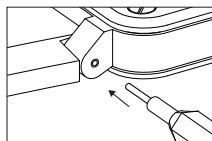
De 4 inbusschroeven (binnenzeskant met diameter van 1,3 mm) houden de horlogeband vast op de bevestigingen van de kast. Het los- en vastdraaien van deze schroeven moet met zorg gebeuren en gebruik hierbij uitsluitend de 2 hiervoor bestemde gereedschappen die in het etui bij het horloge zijn geleverd.
