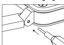
Das Armband ist mit 4 Innensechskantschrauben (1,3 mm Durchmesser) an den Bandanstößen des Gehäuses befestigt. Diese Schrauben müssen vorsichtig mit den beiden zu diesem Zweck vorgesehenen, mit der Uhr in ihrer Schatulle gelieferten Werkzeugen manipuliert werden.
