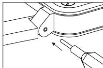
4个内六角螺钉（六角头/直径1.3毫米）将表带固定在表壳连接件上。必须使用腕表盒内随附的两种工具小心处理这些螺钉。
